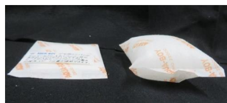
水道水吸水 吸水前 (7 g) 吸水後 (280 g)
